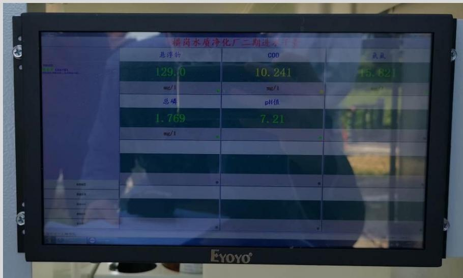
排水在线微型水质站-集中管控面板
