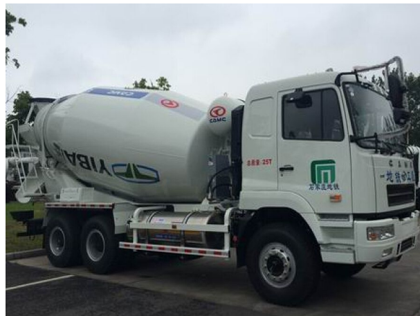
LNG 混凝土搅拌车
