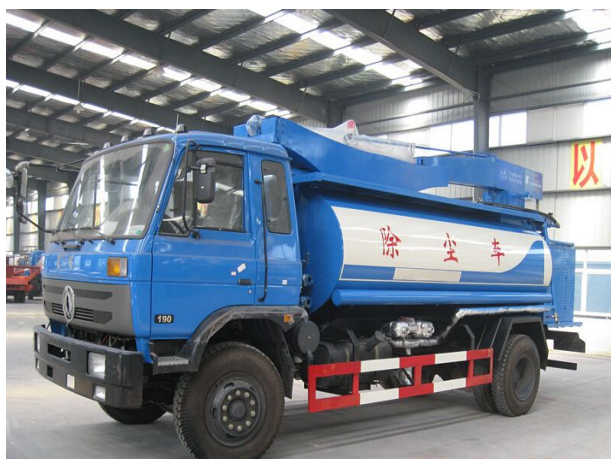
拆除工程抑尘剂喷洒设备--高压喷枪除尘车
