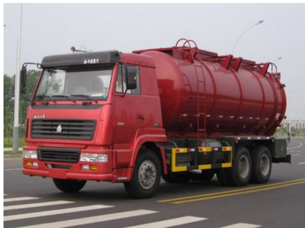
泥浆采用罐车运输
