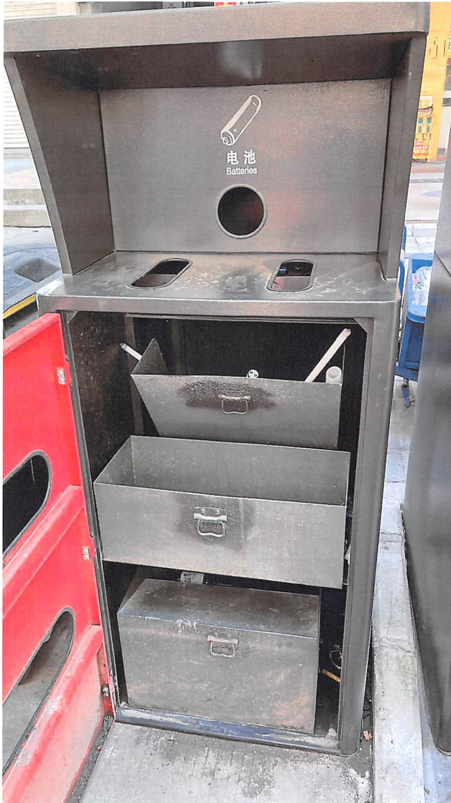
有害垃圾收集容器内部图
