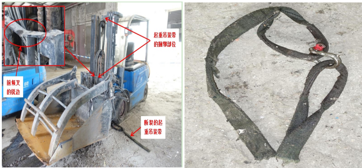
图 8：事发时起重吊装带捆绑情况
