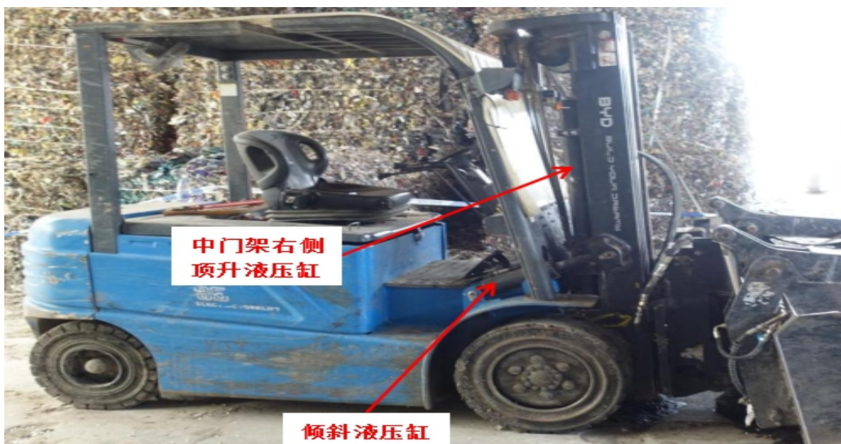
图 6：涉事叉车两个液压缸
